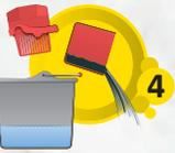
4. Schmutzwasser kann bequem über den separat entnehmbaren Auffangbehälter entleert werden.
